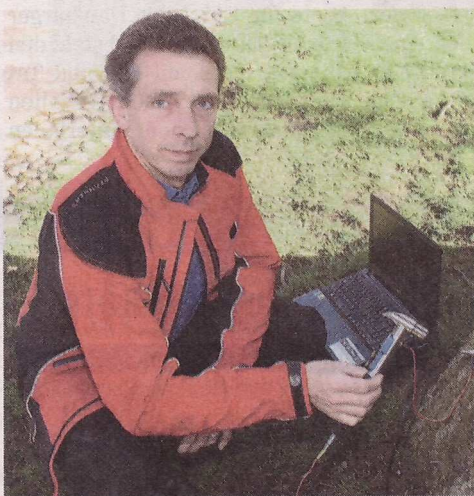
Gerrit Schröder löst mit einem Funkhammer die Impulse für die Messungen aus
